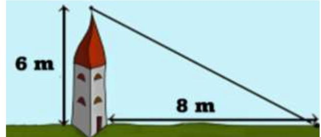
El cable coincide con la hipotenusa de un triángulo rectángulo cuyos catetos medirían:  $a = 6 \text{ m}$  y  $b = 8 \text{ m}$ .
